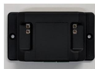
3線式120Ωひずみゲージと接続して利用します。
